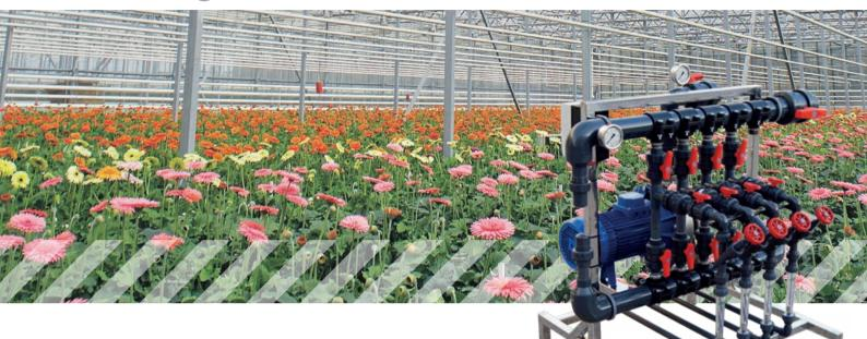
Los equipos de fertirrigación nutrimac están concebidos para la aportación controlada y eficiente de fertilizantes en la red de riego, inyectando manualmente las cantidades que los técnicos determinan adecuadas para satisfacer las necesidades nutricionales del cultivo.
